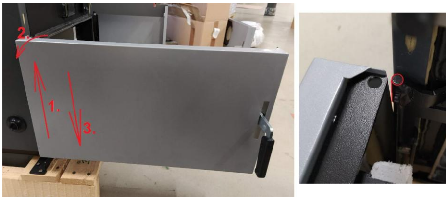
Obrázek 2. Demontáž spodních dvířek kotle (ilustrační foto)
